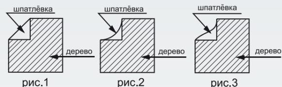
Рис. 1 — зашпатлеванный деревянный брусок со снятой фаской.
